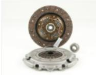
Composition : Disque, mécanisme et butée mécanique
